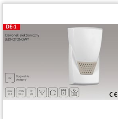
Dzwonek elektroniczny JEDNOTONOWY Typ: DE-1. Napięcie: 250V lub 8V. Stopień szczelności: IP 20. Głośność: 80 dB. Dostępne w kolorach: biały lub beżowy. Cechy szczególne: regulacja głośności dzwonienia.
